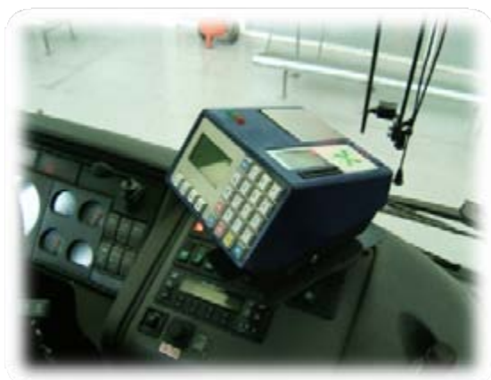
Sistema de validació i venda instal·lat a bord d'un autobús
